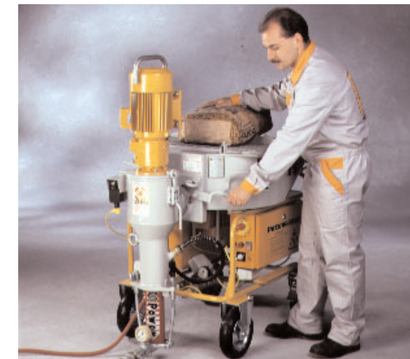
El contenedor del material y el tubo mezclador están separados. Abriendo la tajadera, el mortero seco entra en el tubo mezclador.
