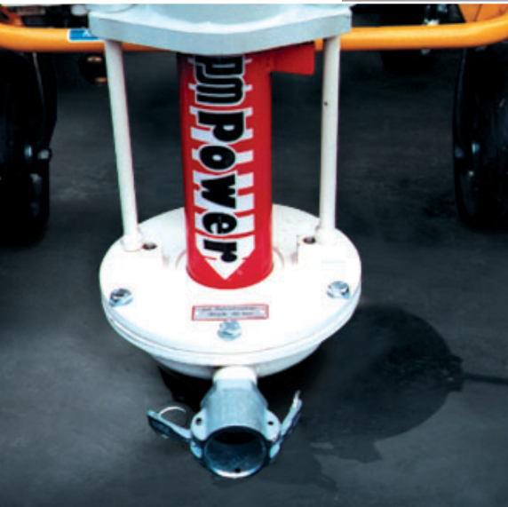
El remezclador Uni para enfoscados ligeros y solado autonivelante como alternativa económica al Dynamat de Putzmeister.
