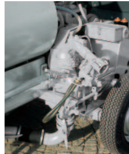
KK 139 - bomba de doble émbolo hasta 160 l/min.
