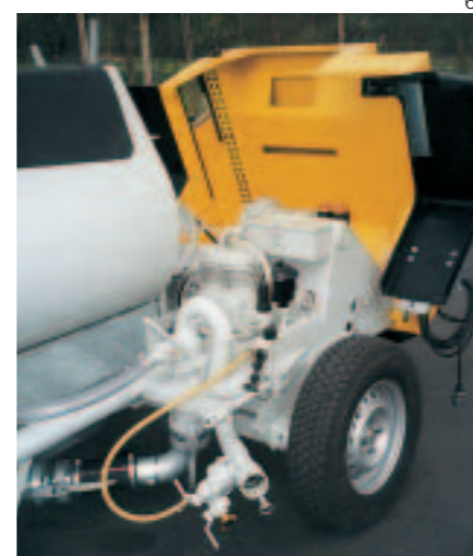
KA 139 - bomba de compensación de doble émbolo, max. 80 l/min., compresor bicilindro de aire comprimido.
